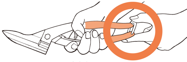
図 1 フックをはずす時は上下の柄を握ってはせず使用後は必ずフックをかける
